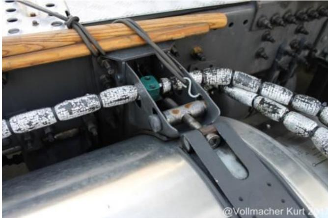
Linee at Foto: dettaglio una delle cinghie del serbatoio LNG
