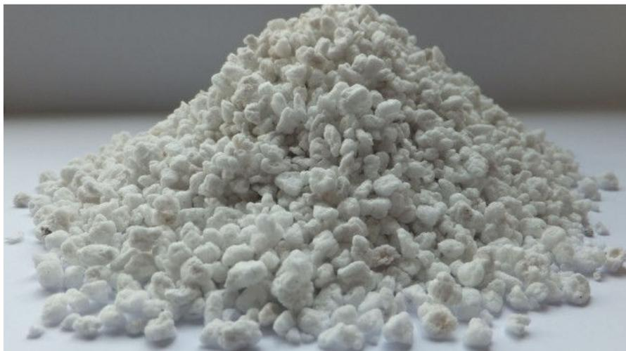
Foto: Perlite, utilizzata come isolante nello spazio anulare del serbatoio Fonte SIBLI
