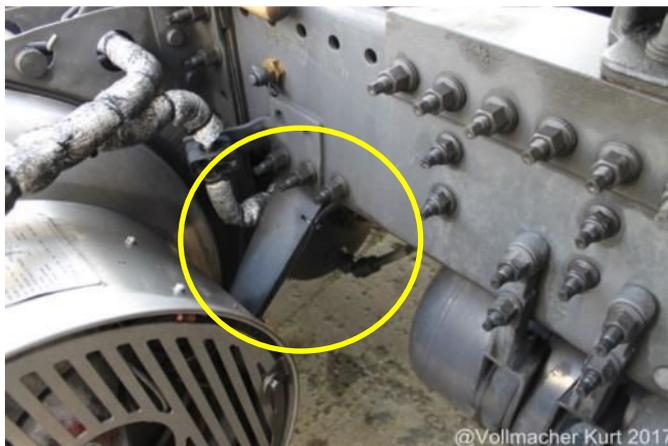
Foto: piastra di montaggio posteriore serbatoio LNG
