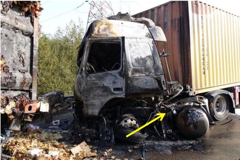
Foto: Il serbatoio è fissato solo con 1 cinghia e piastra posteriore Foto BFM
