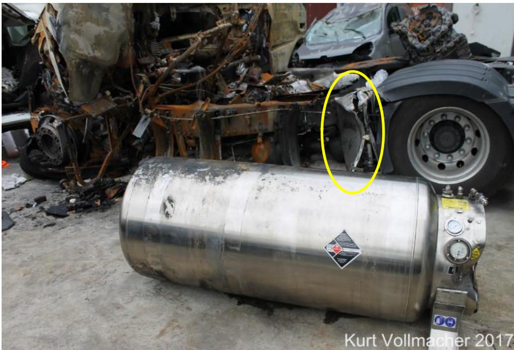
Foto: Le valvole manuali erano inaccessibili.
