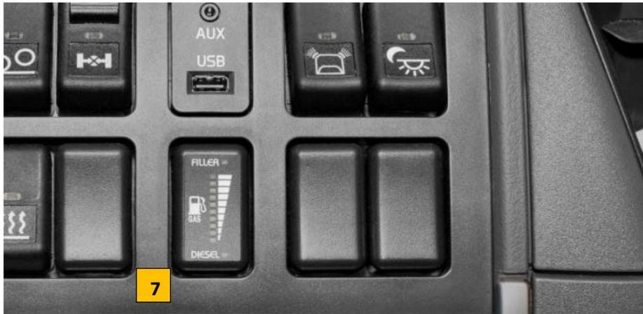
Foto: Misuratore di livello carburante serbatoio
