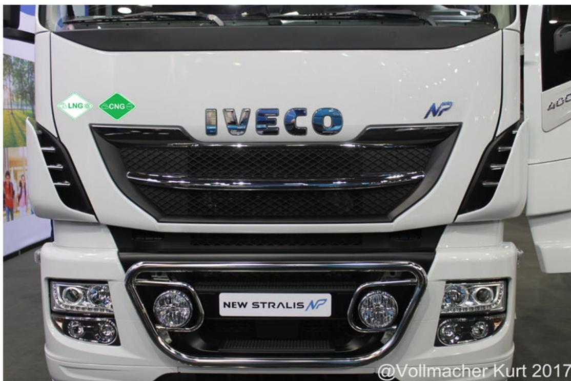
Foto: Marcatura su trattore stradale LNG/GNC (esempio)
