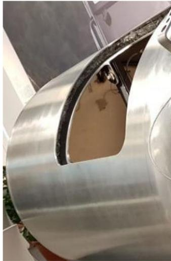
Foto: Esempio di sezione trasversale di un serbatoio di LNG a doppia parete Fonte VOLVO
