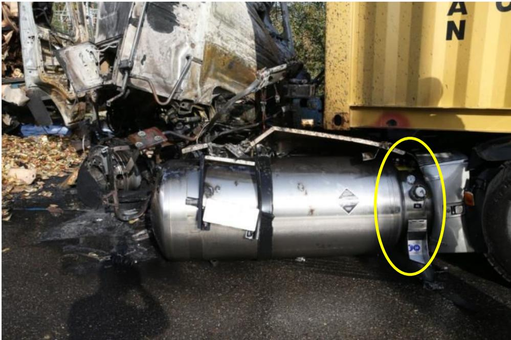
Foto: Valvole/connettori e valvola di sovrappressione non accessibili Foto BFM
