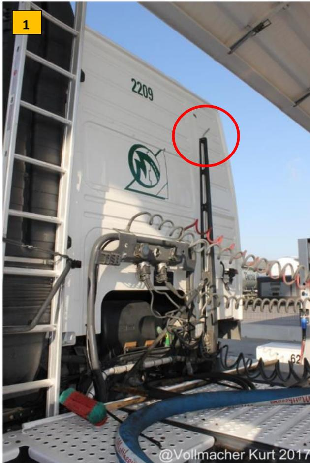
Foto: Linea di ventilazione dietro la cabina di guida
