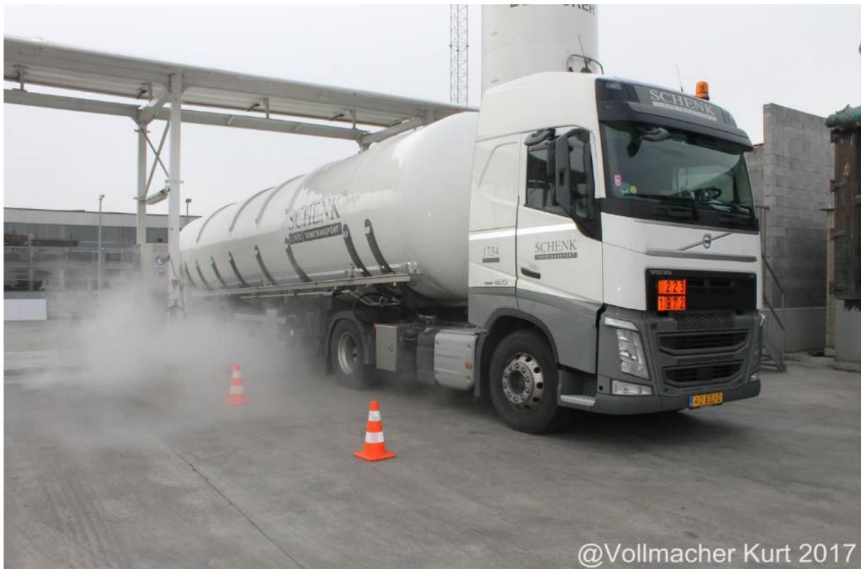
Foto: condensa durante il rilascio di pressione del LNG:
