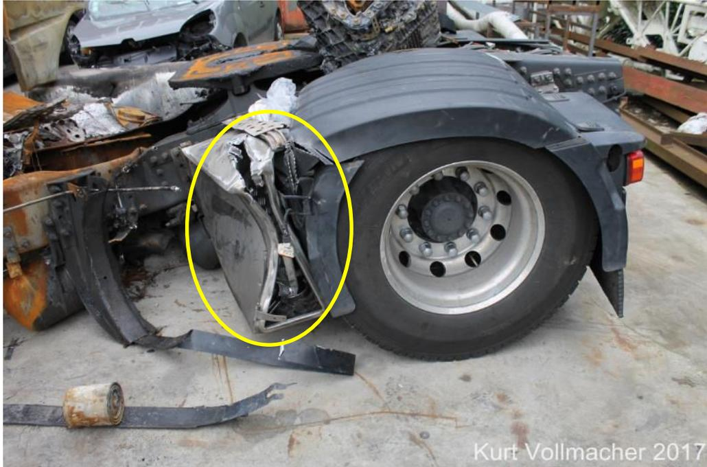
Foto: Le valvole manuali erano inaccessibili.
