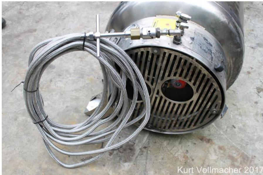
Foto: Tubo criogenico per rilasciare la pressione nel serbatoio.
